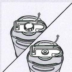
Nettoyez toujours le robinet à l'eau chaude, savonneuse si nécessaire, avant de le placer sur le fût et d'insérer le tuyau.
