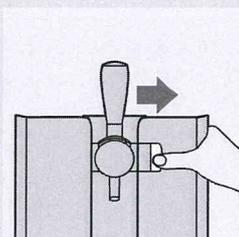
**1** Ouvrez les portes en poussant sur les boutons de déverrouillage vers la droite.
