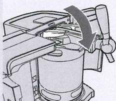
**4** Abaissez les leviers de verrouillage bleus jusqu'en position horizontale.
